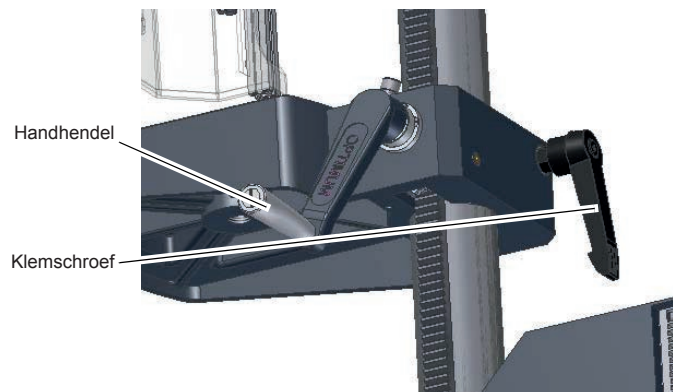
Afb. 4-7: Tafelhoogteaanpassing door middel van hendel en tandheugel
