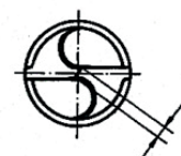
Beitelrandlengte 10% van de boor Ø
