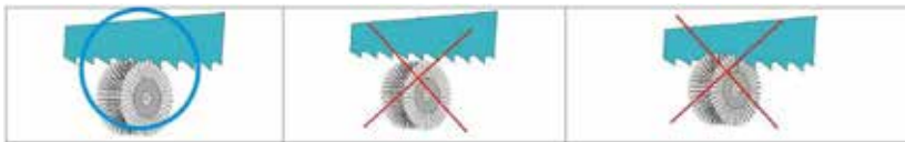
Afb. 27 Links: correcte positie van de spanenborstel
