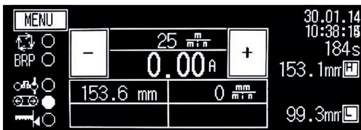
Afb. 30 Weergave bovenste en onderste positie van de zaagarm
