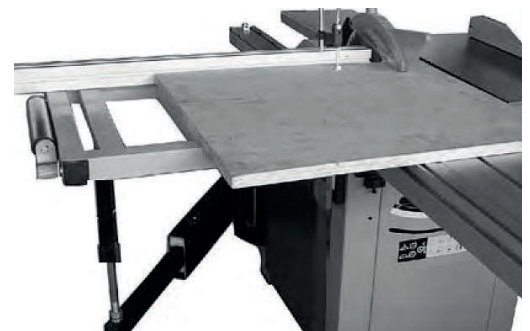
Afb. 33 Zaagproces met schuifselede
