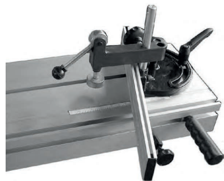
Afb. 41 Schalen voor versteksnedden
