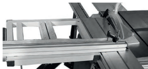
Afb. 37 Aanslag in de achterste positie
