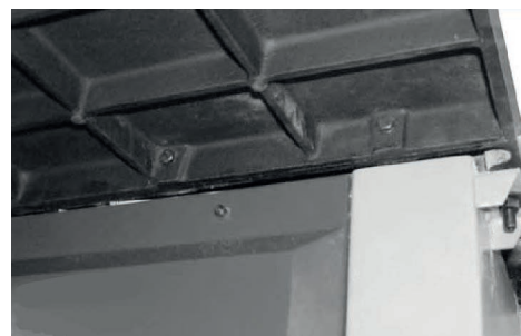
Afb. 11 Montage gietijzeren verlengtafel
