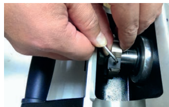
Afb. 15 De snijplaten losschroeven
