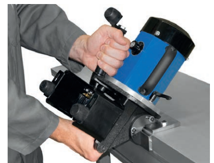
Afb. 9 De machine tegen het werkstuk aanbrengen
