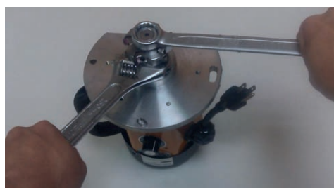
Afb. 16 De freeskop losschroeven
