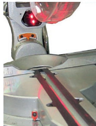
Afb. 4 Laser voor de snijlijn
