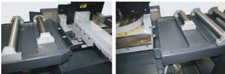
Afb. 23 Direct aangesloten rollenbanen zonder verbindingstukken. Links: voor de materiaalaanvoer Rechts: voor de materiaalafvoer
