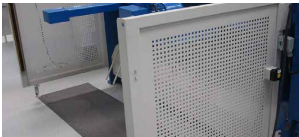
Afb. 8 Achterzonebescherming met zijpanelen en lichtgordijn
