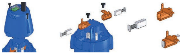
Afb. 12 De koolborstels vervangen
