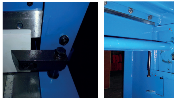
Afb. 9 Neerdrucker (links), stelschroef (rechts)
