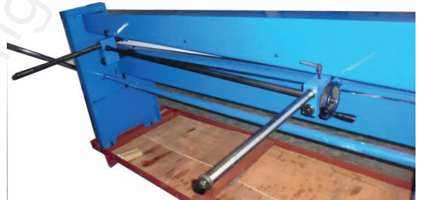
Afb. 5 Montage van de achteraanslag
