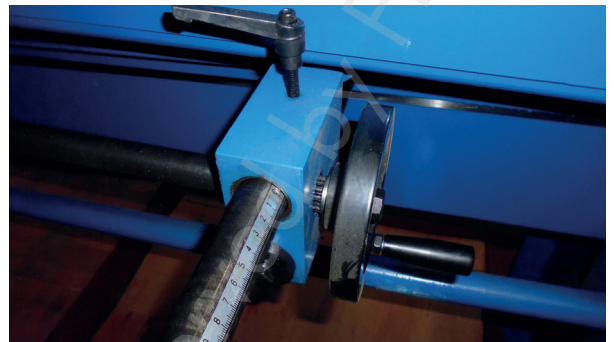
Afb. 10 Instelling achteraanslag : klemschroef, handwiel en schaal
