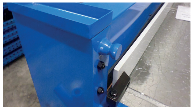
Afb. 6 Instelling van de snijspleet, moeren voor de positie van het bovenmes aan de voorkant
