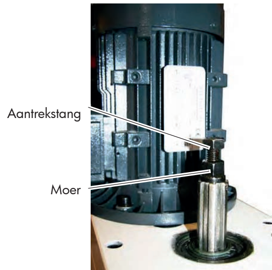
Afb. 4-2 Boorfreeskop zonder beschermkap van de aantrekstang
