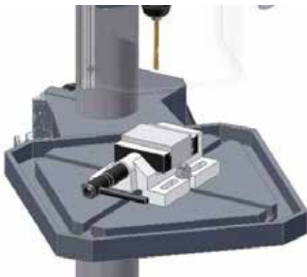
Afb. 5-14 : Bevestiging machineklem met T-moeren
