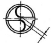
Querschnittenlänge 10% vom Bohrer - Ø
