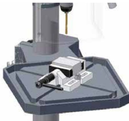
Afb. 4-12 : Bevestiging machineklem met T-moeren
