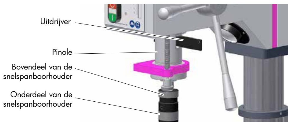
Afb. 4-9 : Demontage met uitdrijver
