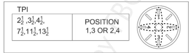
Fig. 61 Groupe de chiffres opposés sélectionnés sur le cadran pour un filetage fractionnaire 1/2
