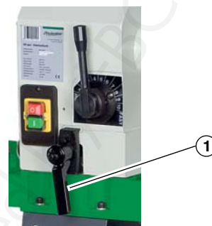
Fig. 7 : Montage klemhendel van de losse kop
