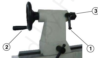
Fig. 10 : Het meelopende center van de losse kop vervangen
