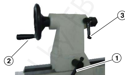
Fig. 13 : Afstellen losse kop
