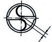
Querscheidenlänge 10% vom Bohrer - Ø
