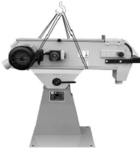
Afb. 4-2: Transport met een kraan (na het uitpakken).
