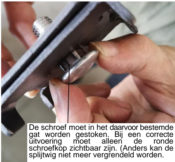
Fig. 19: Montage spouwmes deel 1
