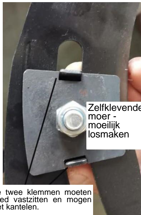
Fig. 21: Montage spouwmes deel 3
