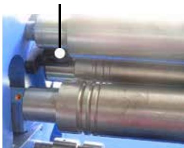
Afb. 14: Conisch buigen: Werktuig en koppelingen
