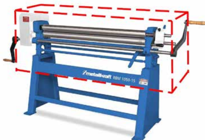
Afb. 7: Gevarenzone van het roltoestel
