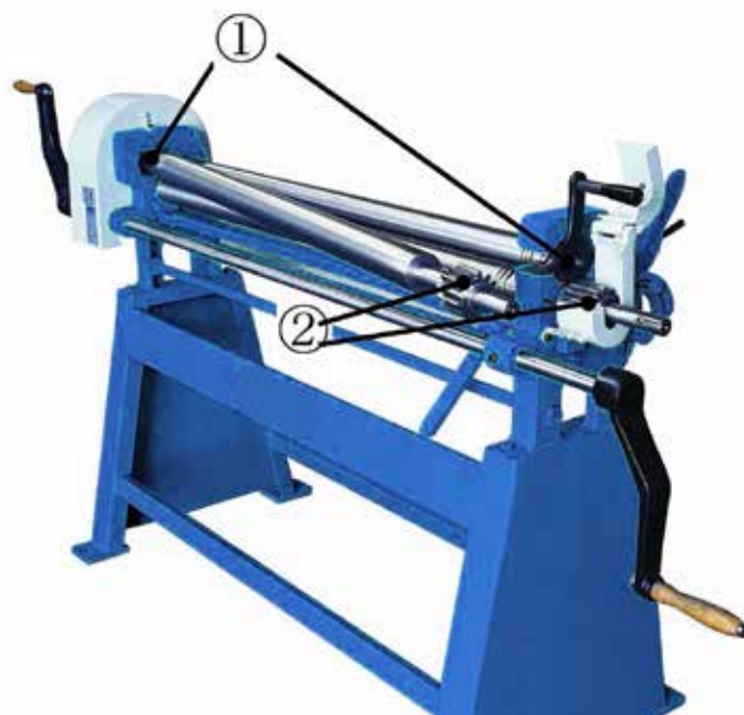
Afb. 19: In te smeren plaatsen aan het roltoestel
