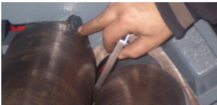
Fig. 17: evenwijdigheid van de walsen controleren
