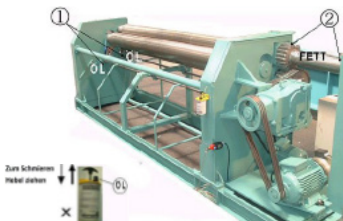
Fig. 24: Te smeren onderdelen van de machine
