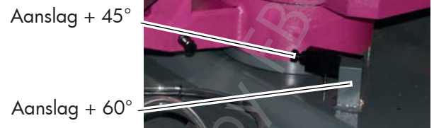
Afb. 5-8: Versteksneede van 0^\circ tot +60^\circ
